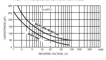
FIG.2- TYPICAL REVERSE CHARACTERISTICS
